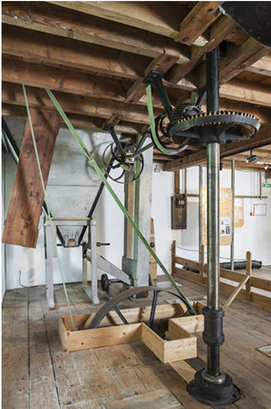
Deuxième étage. Système de transmission.
