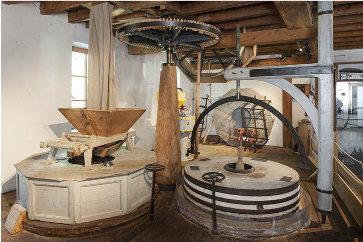
Premier étage. Meules, potence et transmission.
