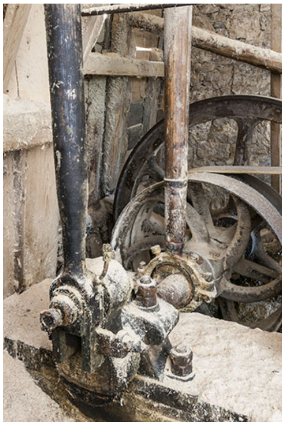
Bielle de transmission de l'axe secondaire (étage de soubassement) au châssis de scie. 25, Chapelle-des-Bois, lieudit : Les Mortes
