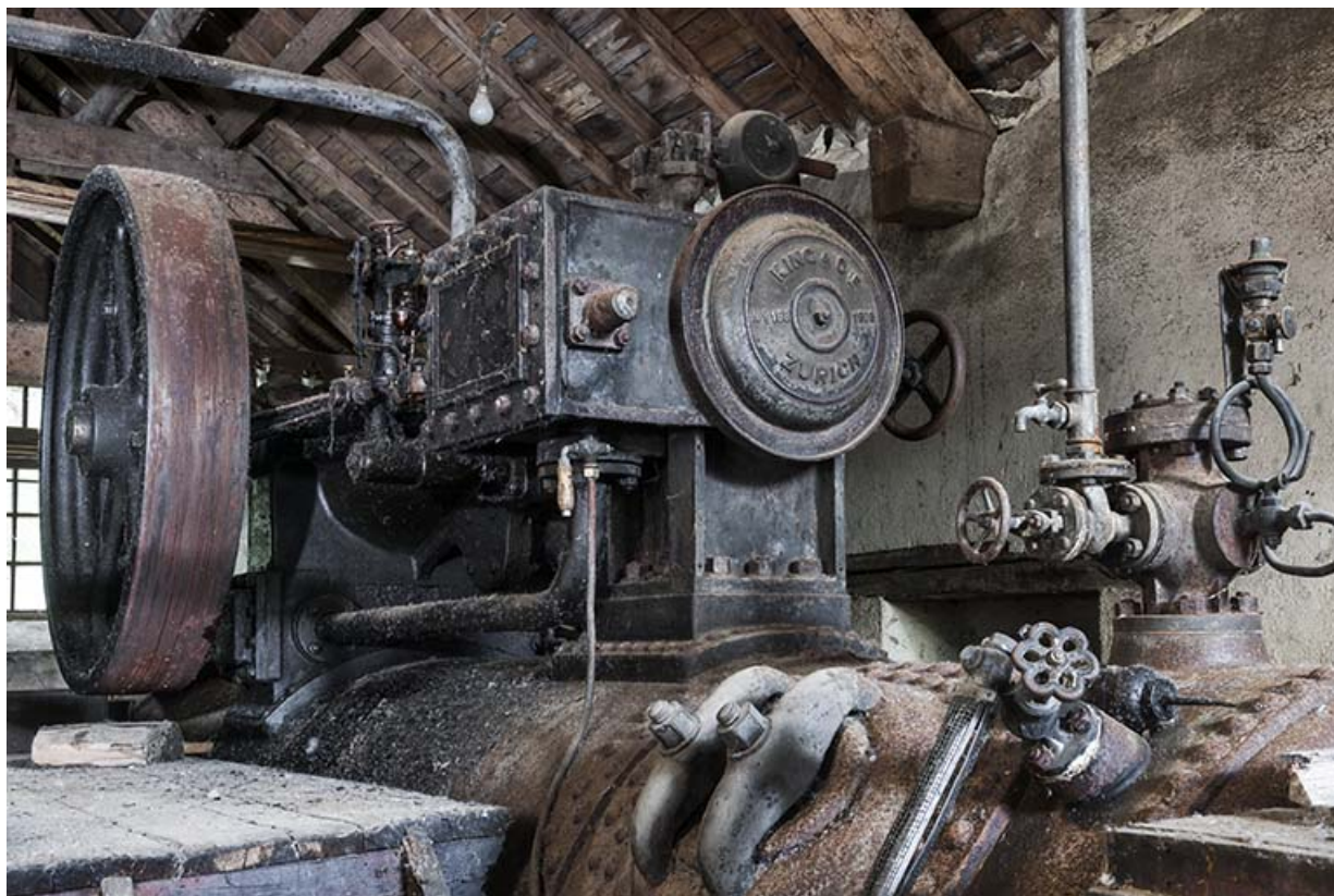
Volant d'inertie et cylindre de la machine à vapeur.
