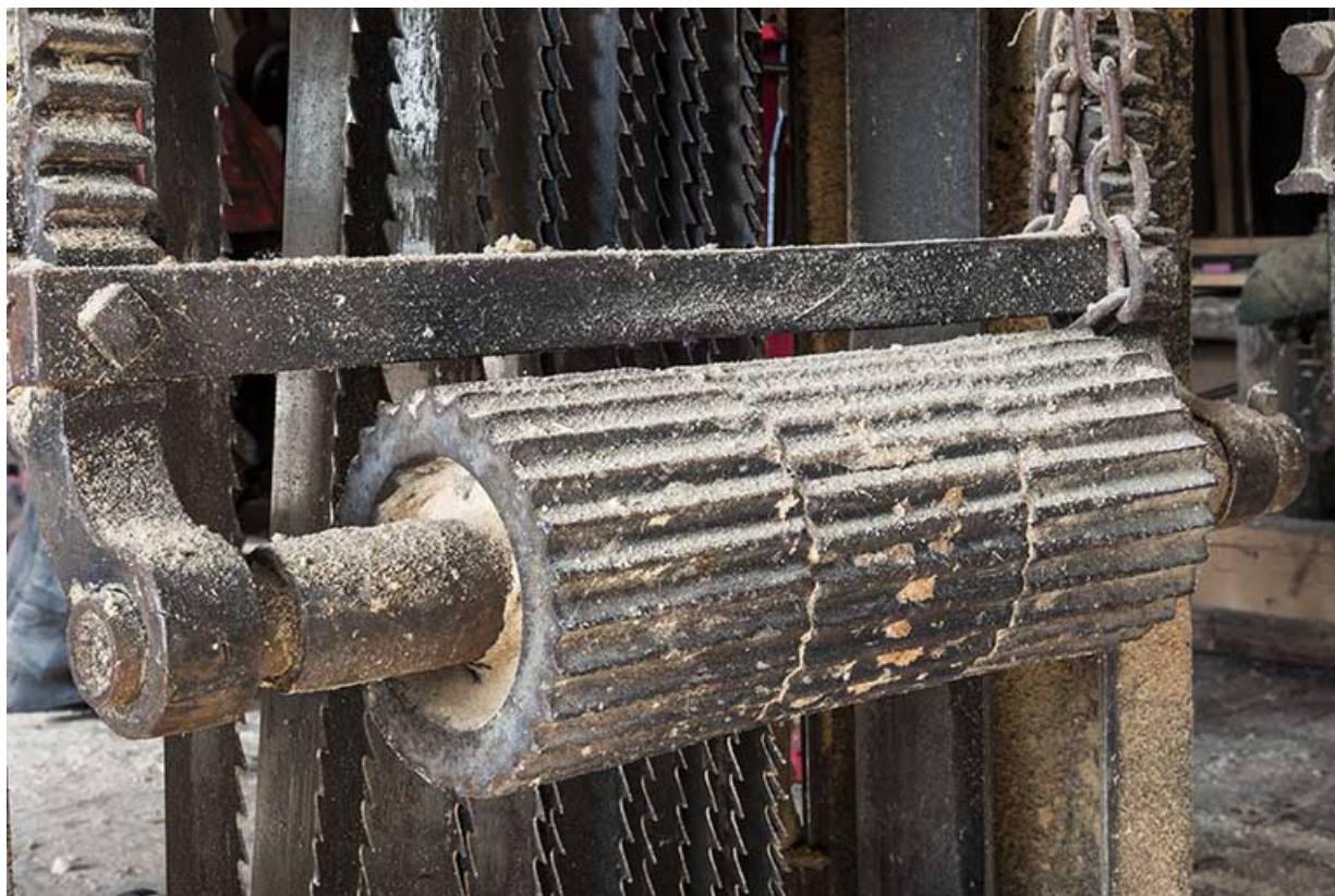
Châssis de scie. Détail d'un cylindre d'avancée de la grume.
