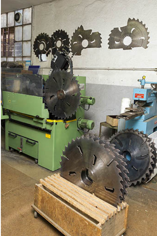
Atelier d'affûtage (K) : machine pour l'affûtage des lames de scie circulaire. 25, Maîche rue de la Scierie
