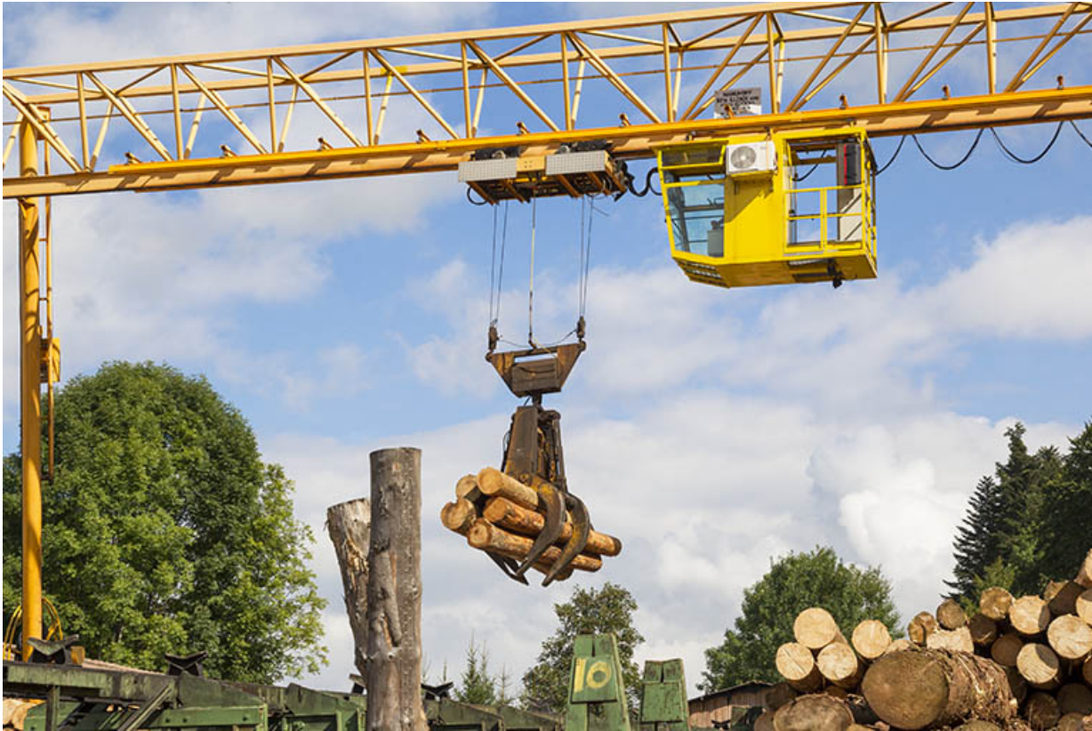
Portique roulant : transport de grumes.
