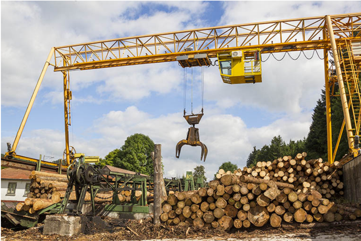
Portique roulant : déplacement de la pince.
