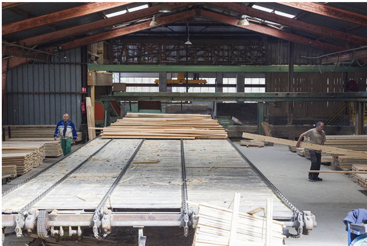
Atelier de triage et d'empilage (G) : convoyeur. 25, Maïche rue de la Scierie
