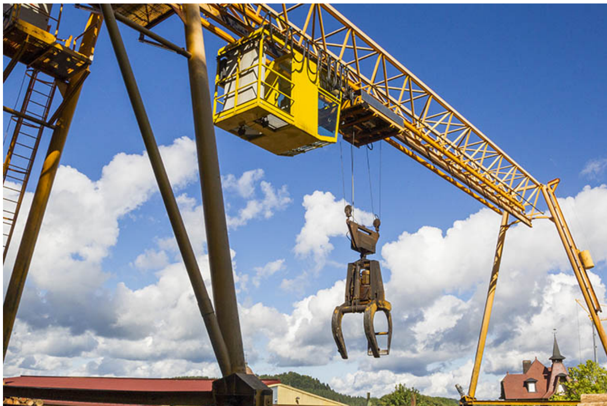
Portique roulant : cabine de commande et pince.
