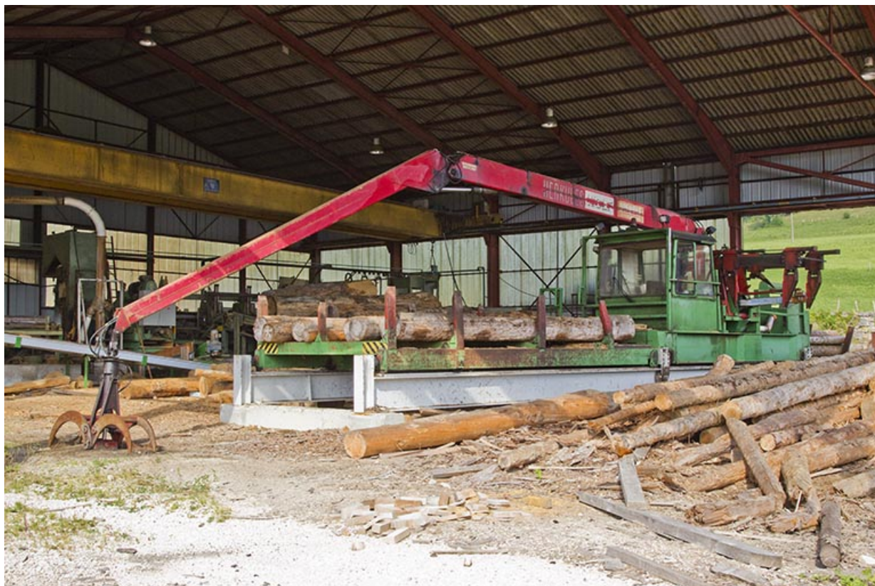
Parc aux grumes : scie sur chariot mobile Herkules.
