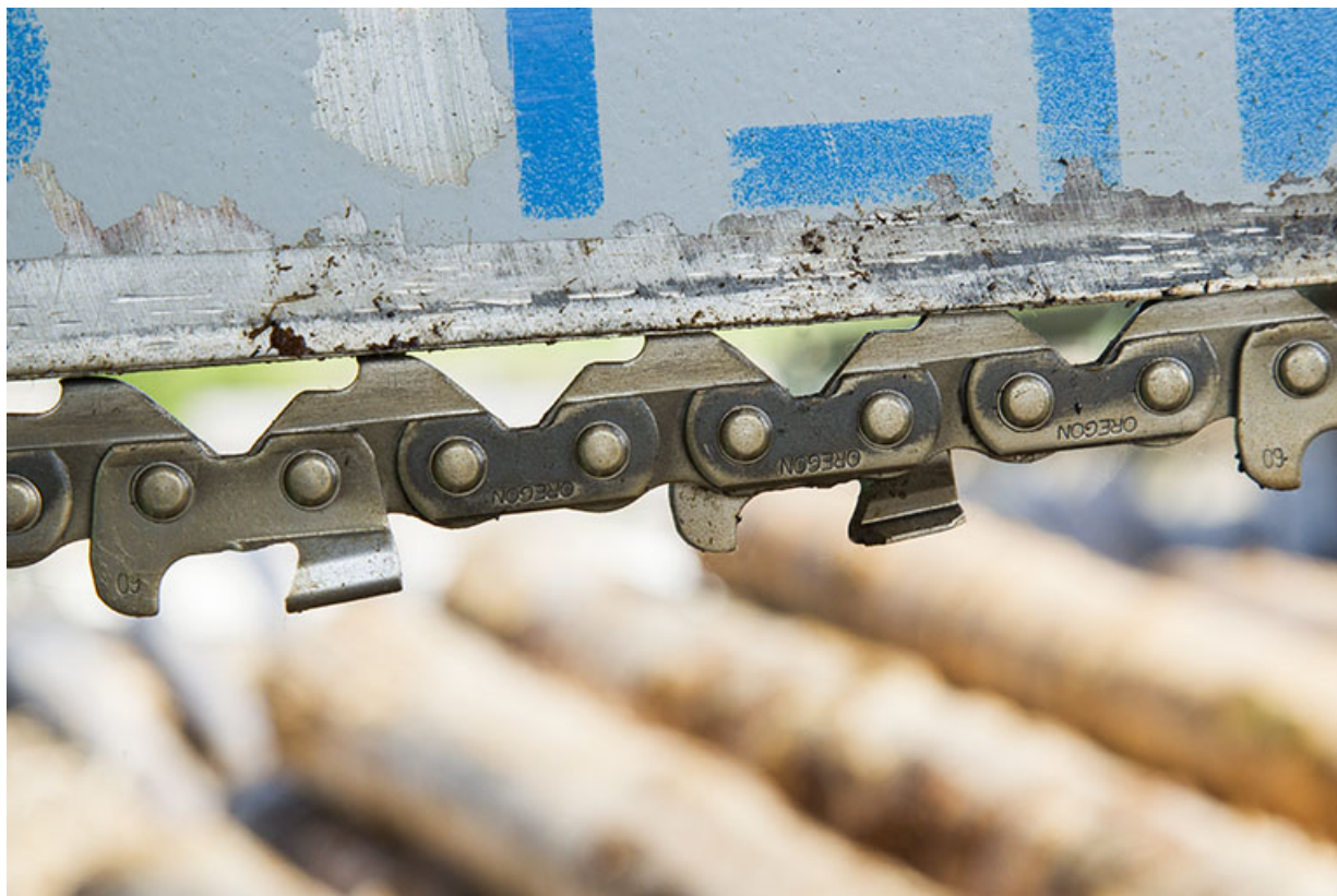
Parc aux grumes : bras de sciage de la scie Herkules (détail de la chaîne). 25, Cour-Saint-Maurice, 10 Rue Grande
