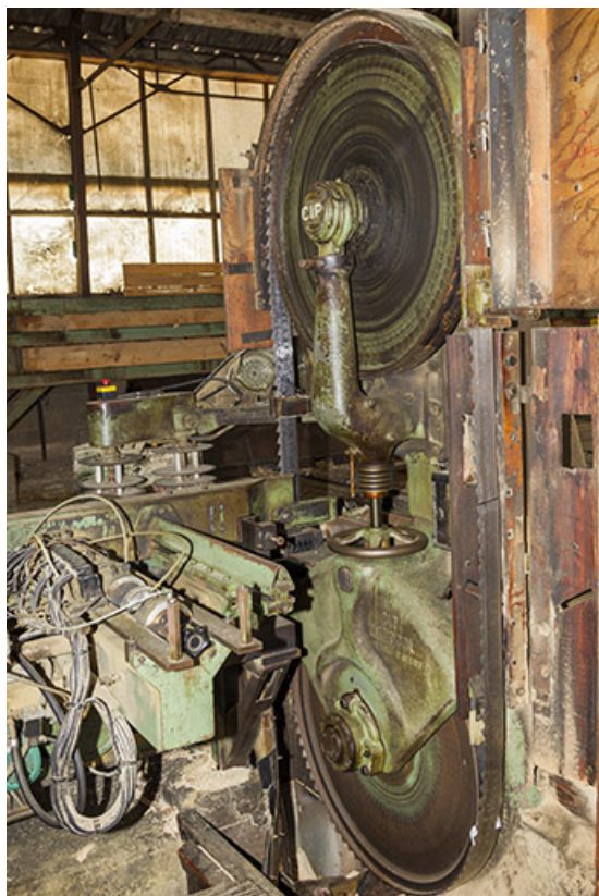
Atelier de fabrication de 1953 : volants et lame de la scie CIP Marqcol. 25, Cour-Saint-Maurice, 10 Rue Grande
