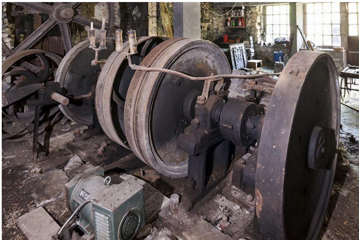
Volants du martinet et arbre à cames.
