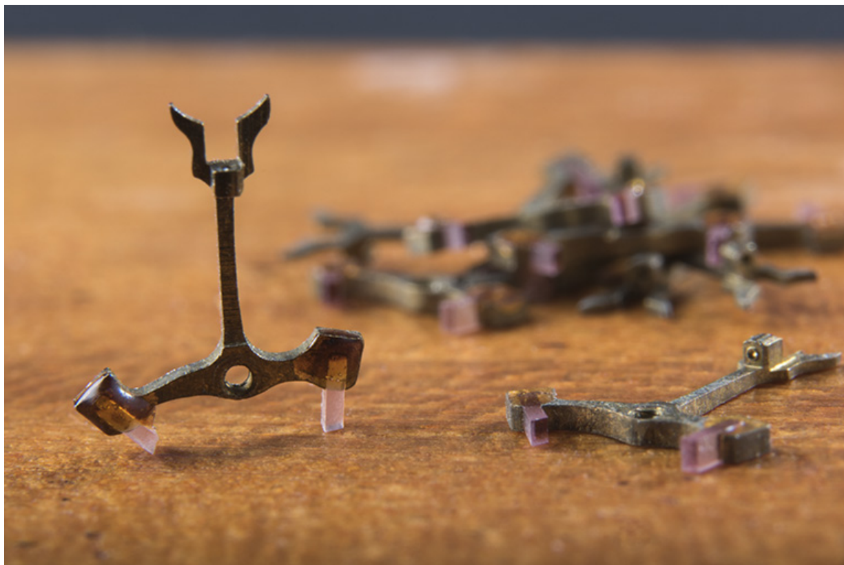
Ancres de montre (collection Jean-Claude Vuez, Villers-le-Lac). Celle placée verticalement repose sur ses deux palettes en rubis et présente sa fourchette en partie haute. Le paquet porte l'inscription : "10 fourchettes / 18" [...] / vis sans fin".
