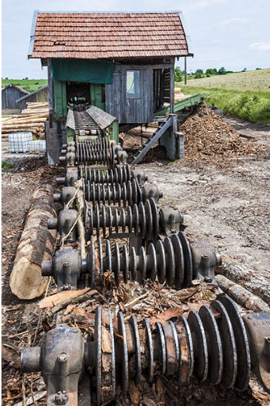
Rouleaux d'entraînement du poste d'écorçage.
