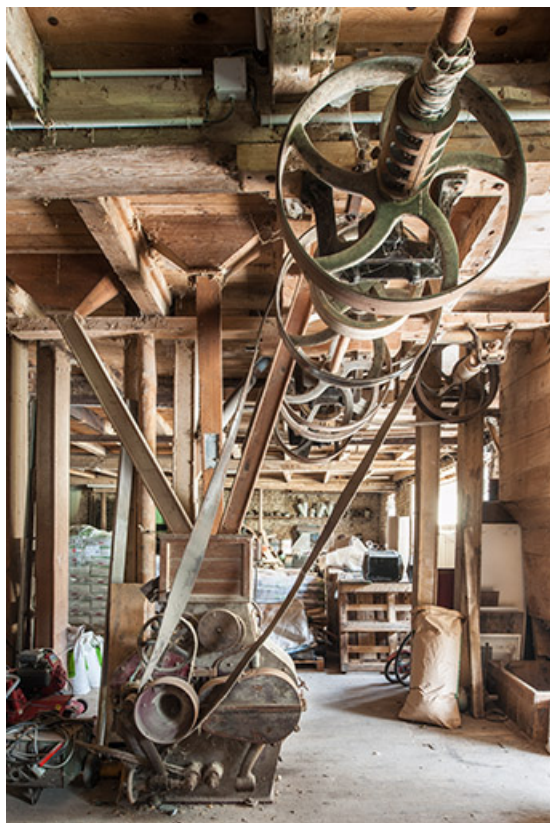
Rez-de-chaussée surélevé. Broyeur à cylindres Lacroix et le système de transmission. 25, Villers-Chief, lieudit : Creuse
