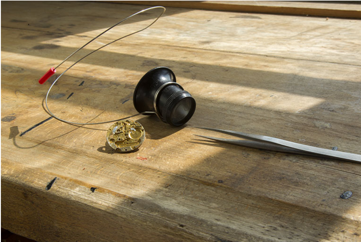
Atelier de fabrication : ébauche, brucelles et loupe d'horloger (dite "microscope" ou "micros"). 25, Charquemont
