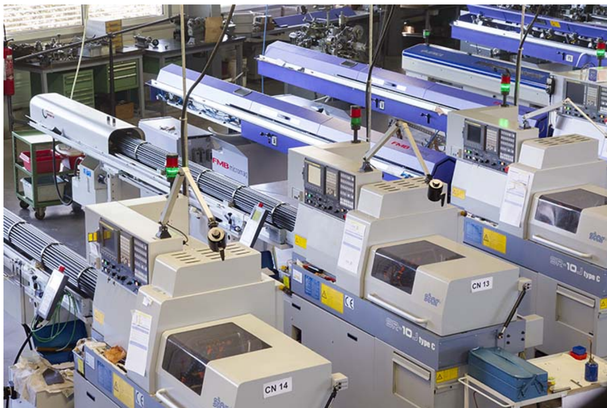
Machines à décolleter Star (vue rapprochée). 25, Charquemont rue Pierre Mendès-France
