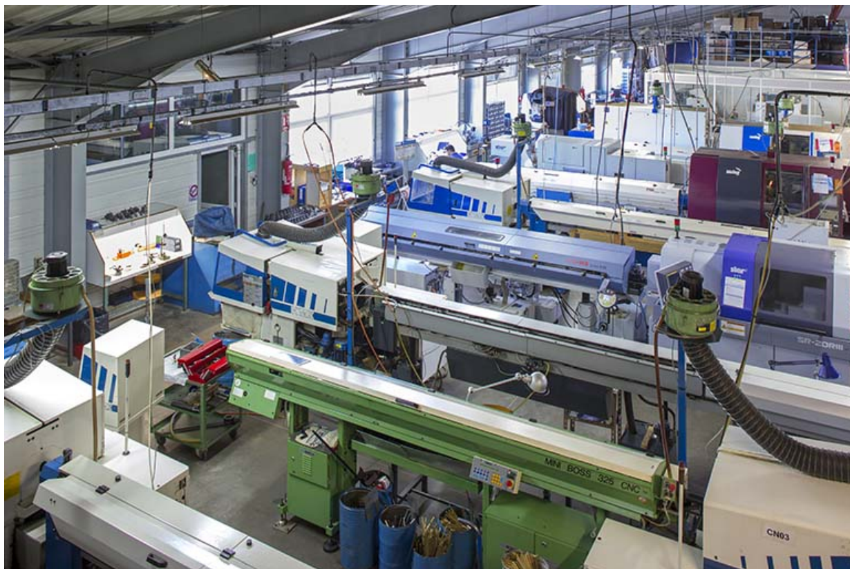
Machines à décolleter à commande numérique (côté nord).
