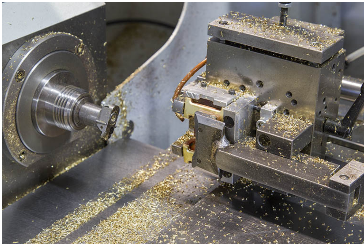
Tour à diamant (vue rapprochée).
