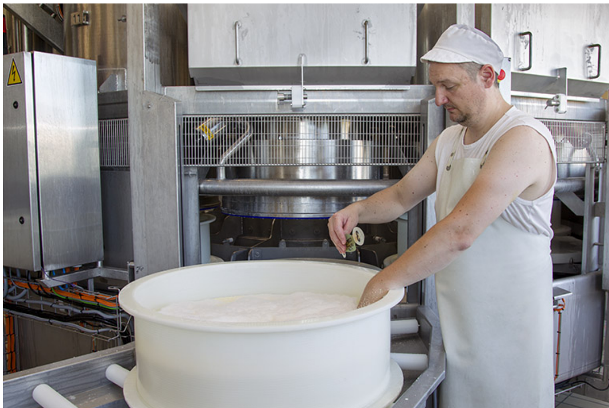
Fabrication : mise en place de la plaque verte (" carte d'identité " de la meule de comté). 25, Charquemont, 6 rue Pierre Mendès-France
