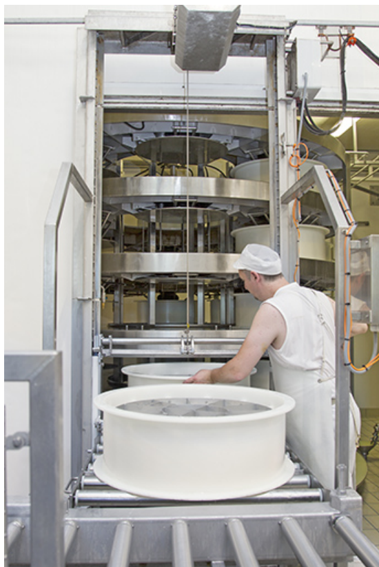
Fabrication : insertion d'un moule dans la presse tournante.
