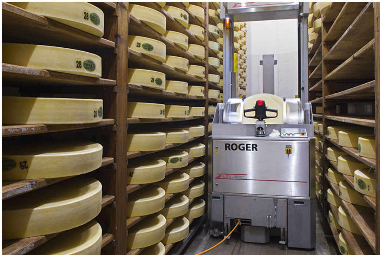
Affinage du comté : le robot de soins (vue rapprochée, avec retournement d'une meule). 25, Charquemont, 6 rue Pierre Mendès-France
