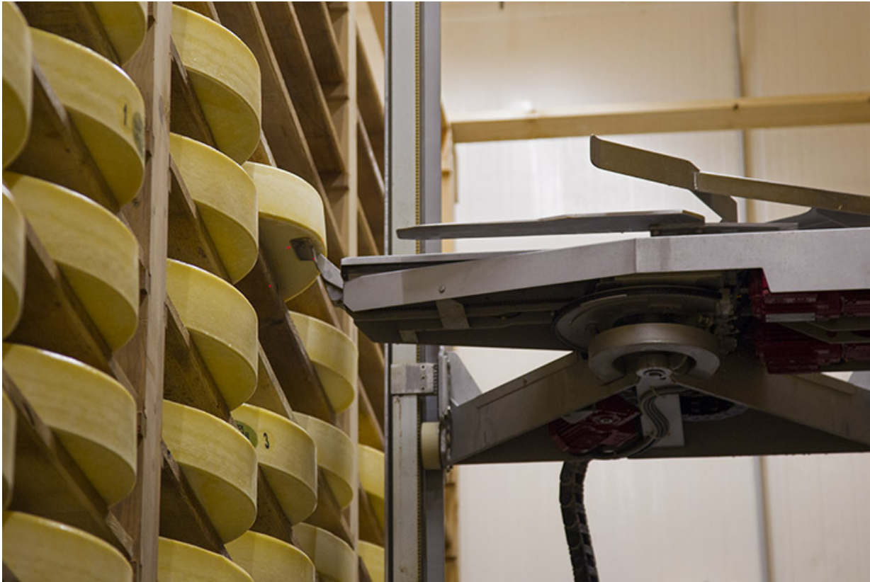
Affinage du comté : robot soulevant une meule.
