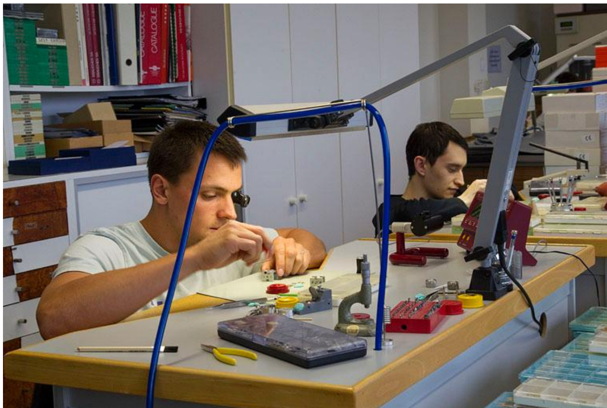
Atelier du service après-vente : réglage du mouvement.
