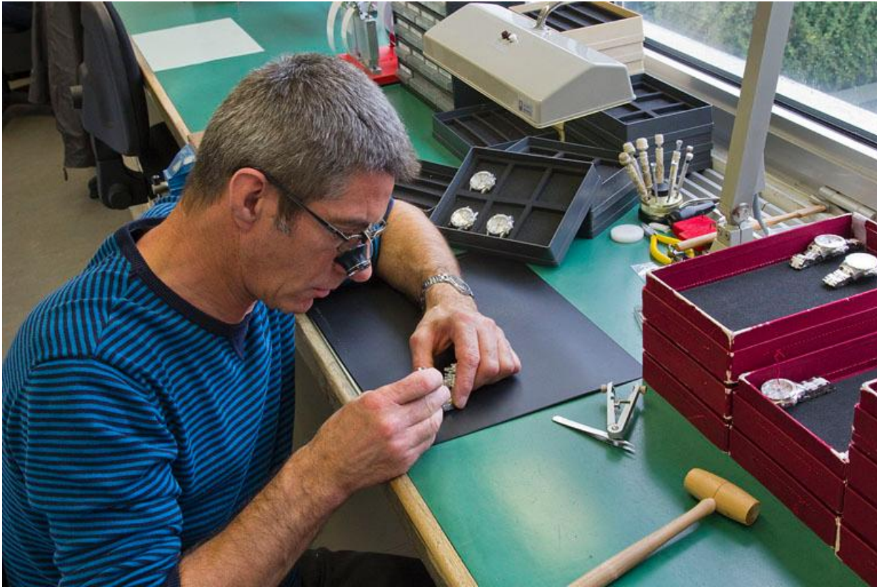
Atelier de fabrication : pose du bracelet.
