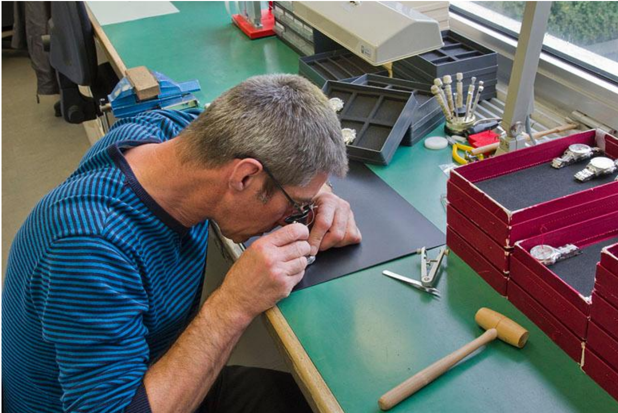
Atelier de fabrication : pose du bracelet.
