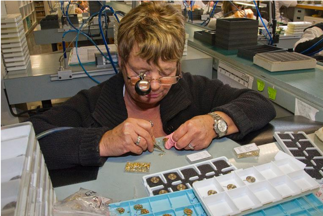
Atelier de fabrication : pose des aiguilles.
