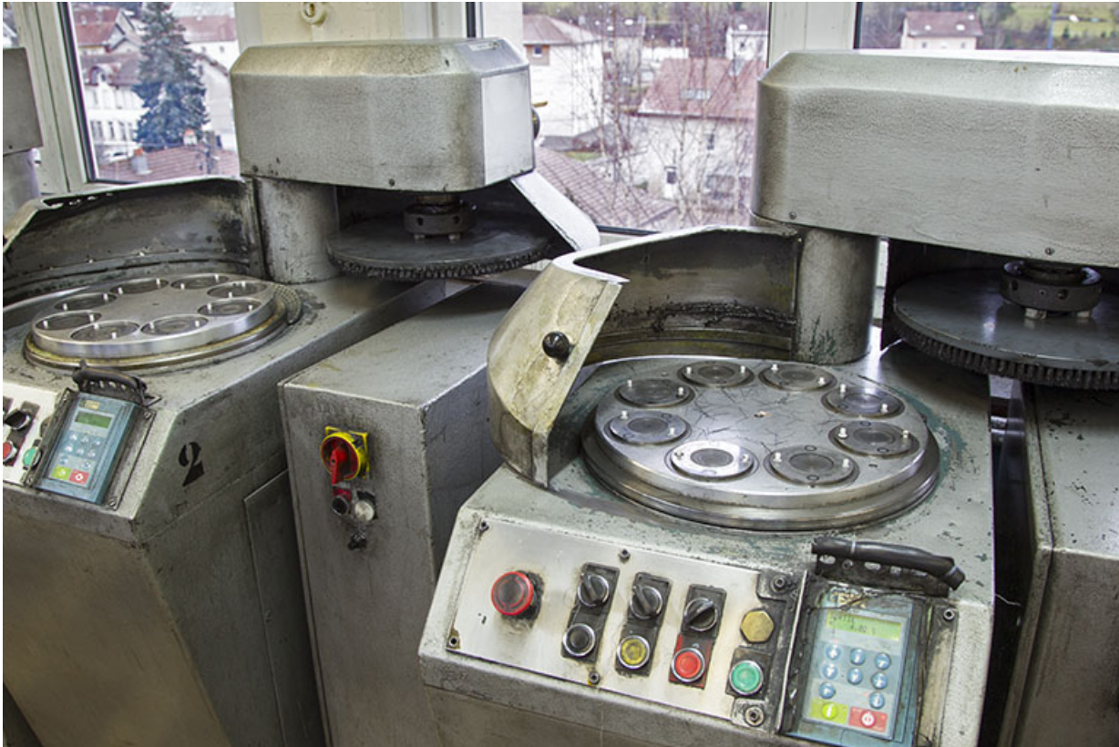
Atelier de polissage : machines à polir à brosse.
