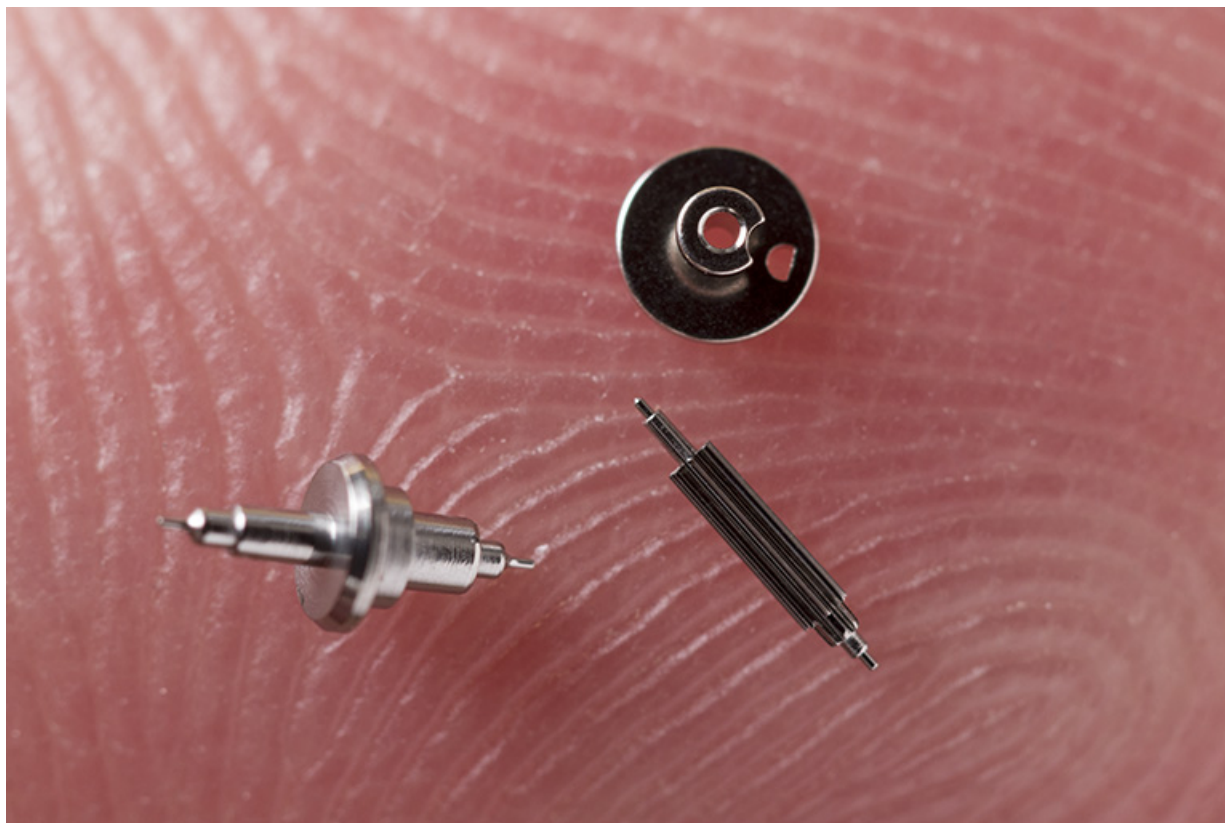
Exemples de composants fabriqués dans l'usine : axes de balancier, plateaux et pignons d'échappement.
