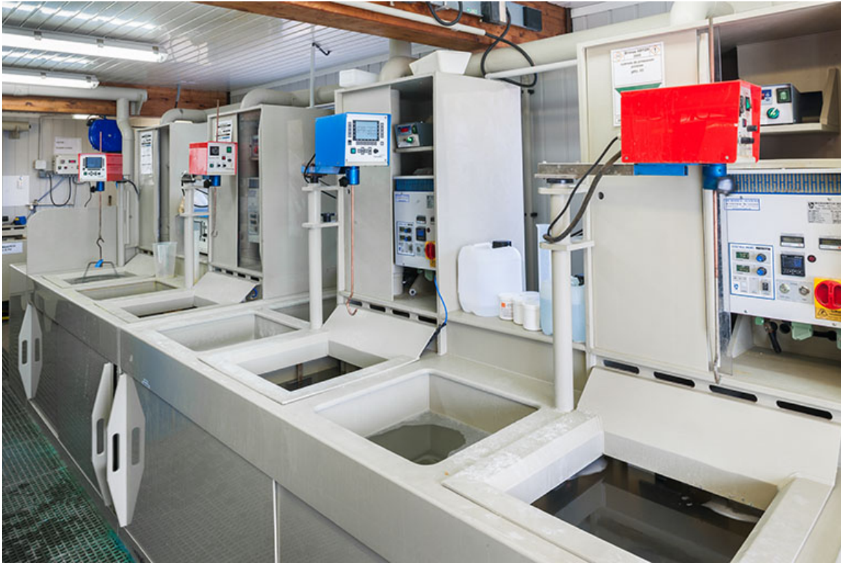
Usine : atelier de galvanoplastie (installations à l'arrière de la façade latérale gauche). 25, Frambouhans, 4 rue de la Velle
