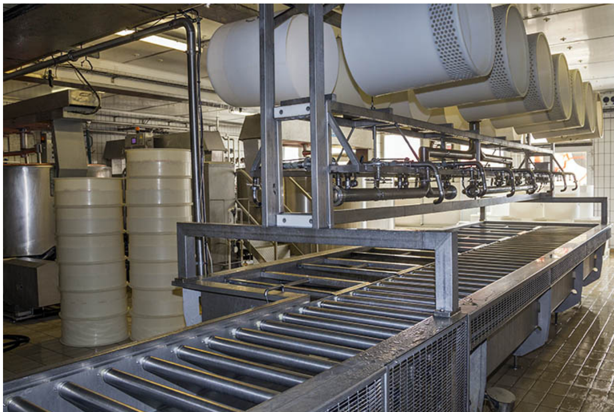
Installation de soutirage par pompe à caillé : le répartiteur. Au premier plan, le convoyeur permettant le transfert des moules sous l'installation de pressage.
