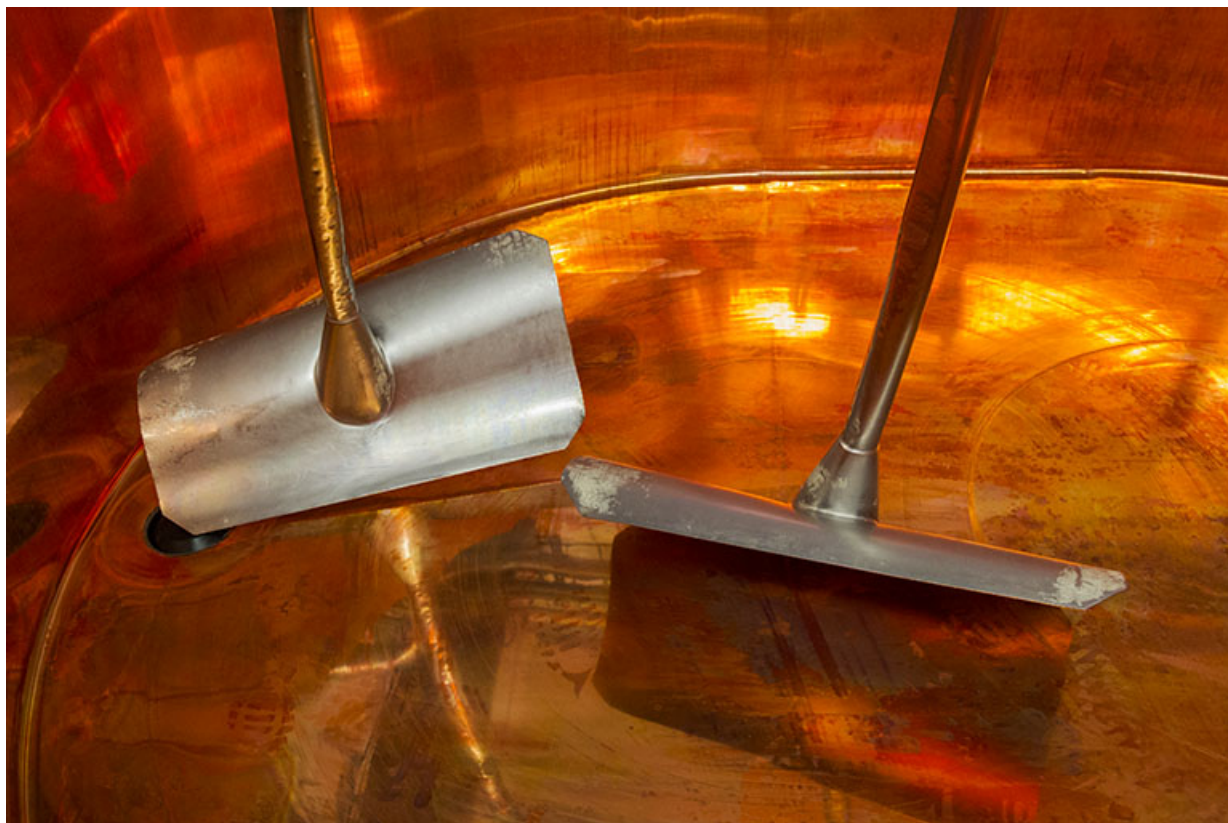
Cuve de fabrication standard : outils de brassage.
