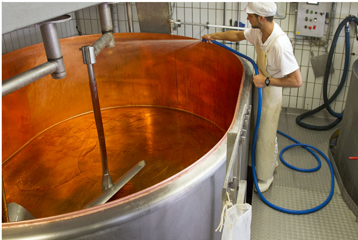
Nettoyage des installations : intérieur d'une cuve de fabrication standard.
