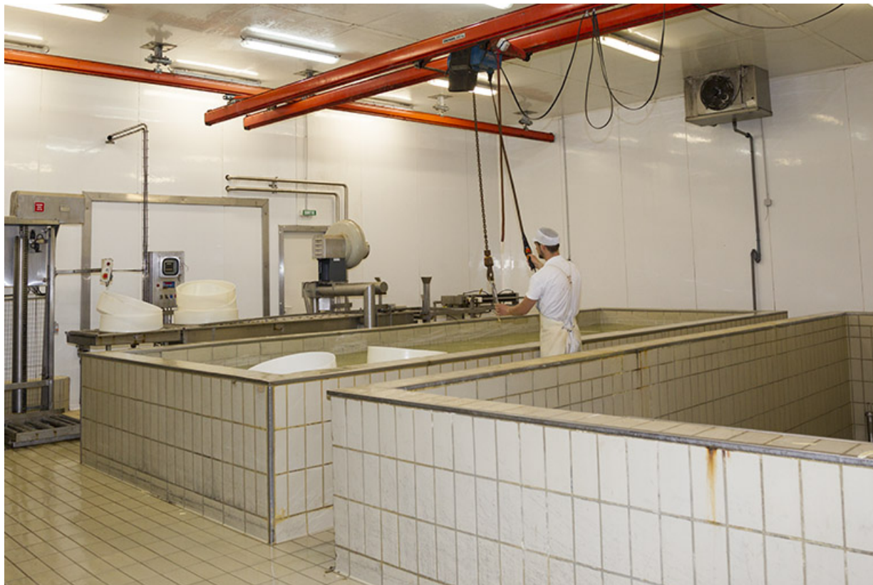
Atelier des cuves à saumure (" bains de sel "). 25, Tréviillers, 8, 11 rue des Fruitières
