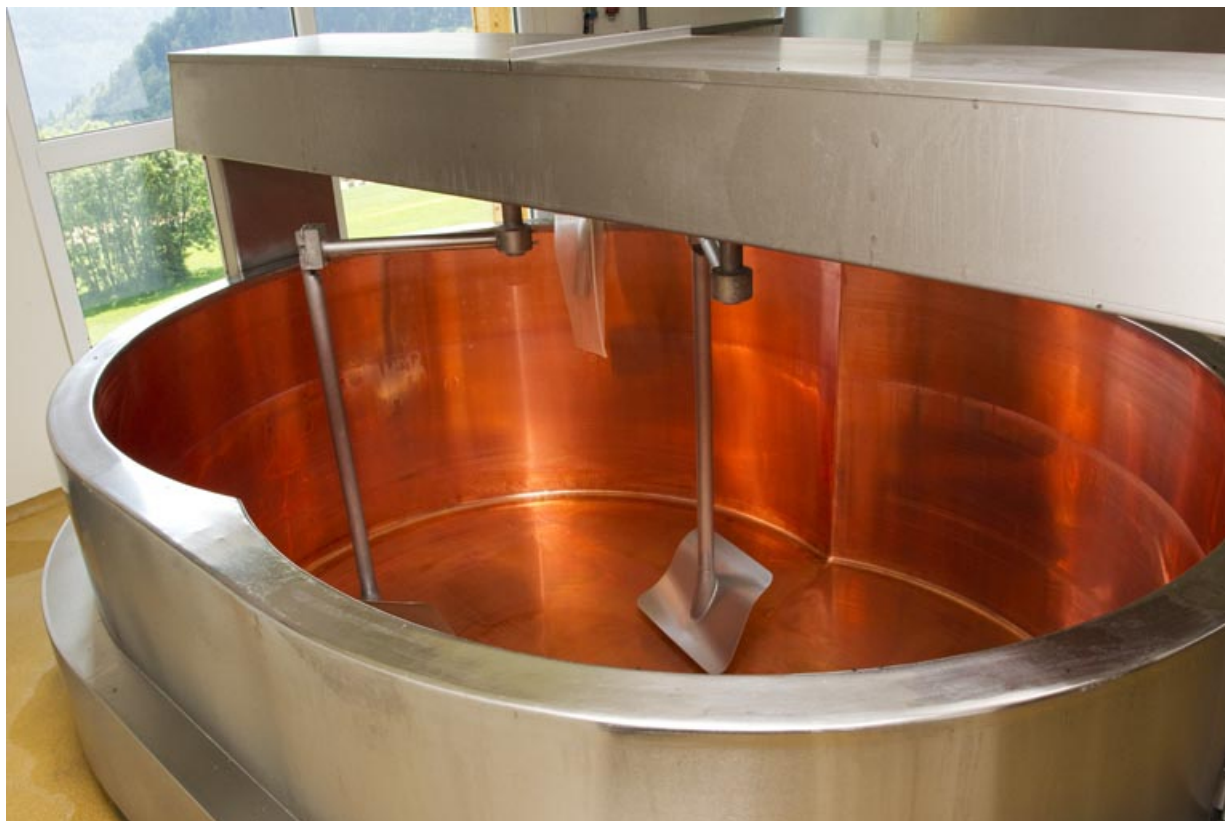
Cuve de fabrication : vue plongeante montrant l'intérieur.
