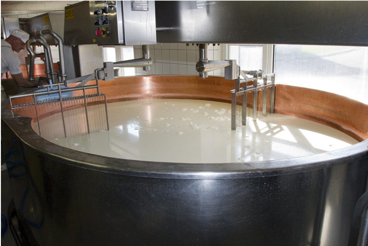
Fabrication du comté : deuxième cuve, équipée des tranche-caillé.
