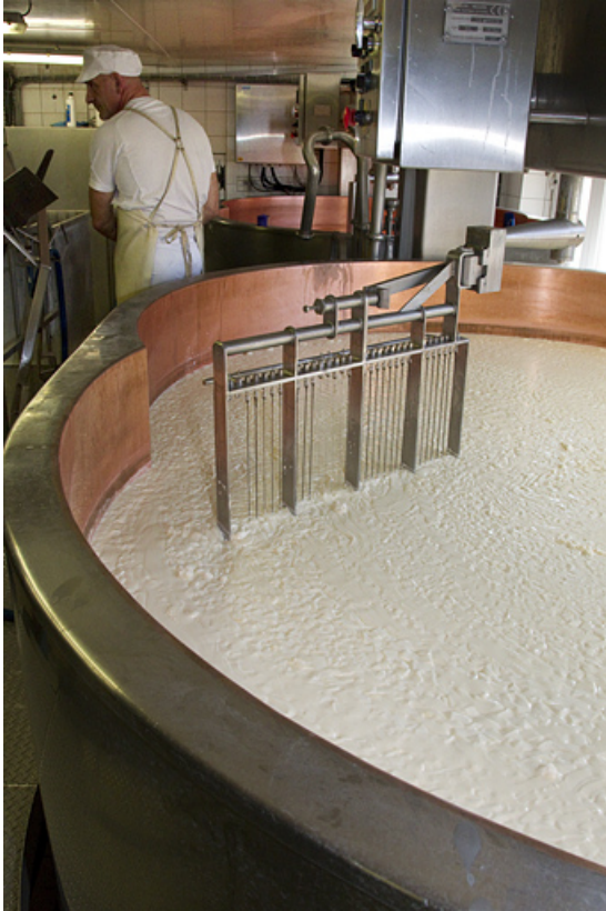
Fabrication du comté : caillé dans la deuxième cuve.
