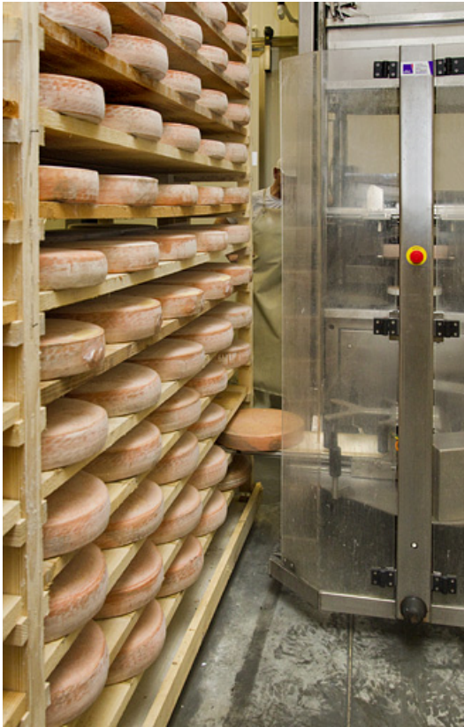
Fabrication du morbier : robot prenant une meule. 25, Damprichard, 20 rue des Ecoles
