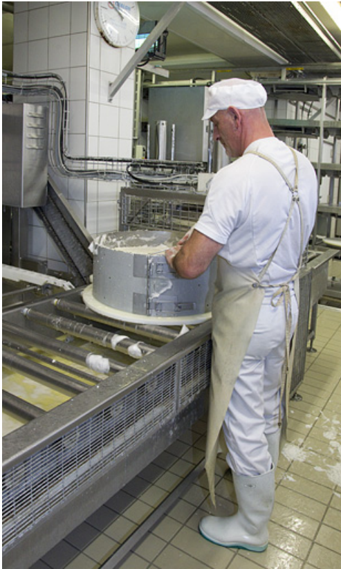
Fabrication du comté : enlèvement de l'écume du moule rempli de caillé. 25, Damprichard, 20 rue des Ecoles
