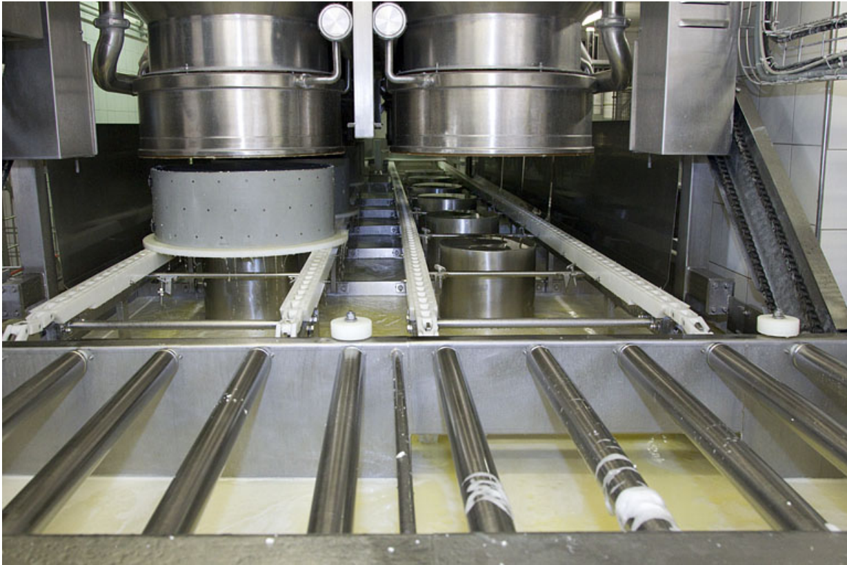
Fabrication du comté : installation de soutirage (cloches et moule). 25, Damprichard, 20 rue des Ecoles
