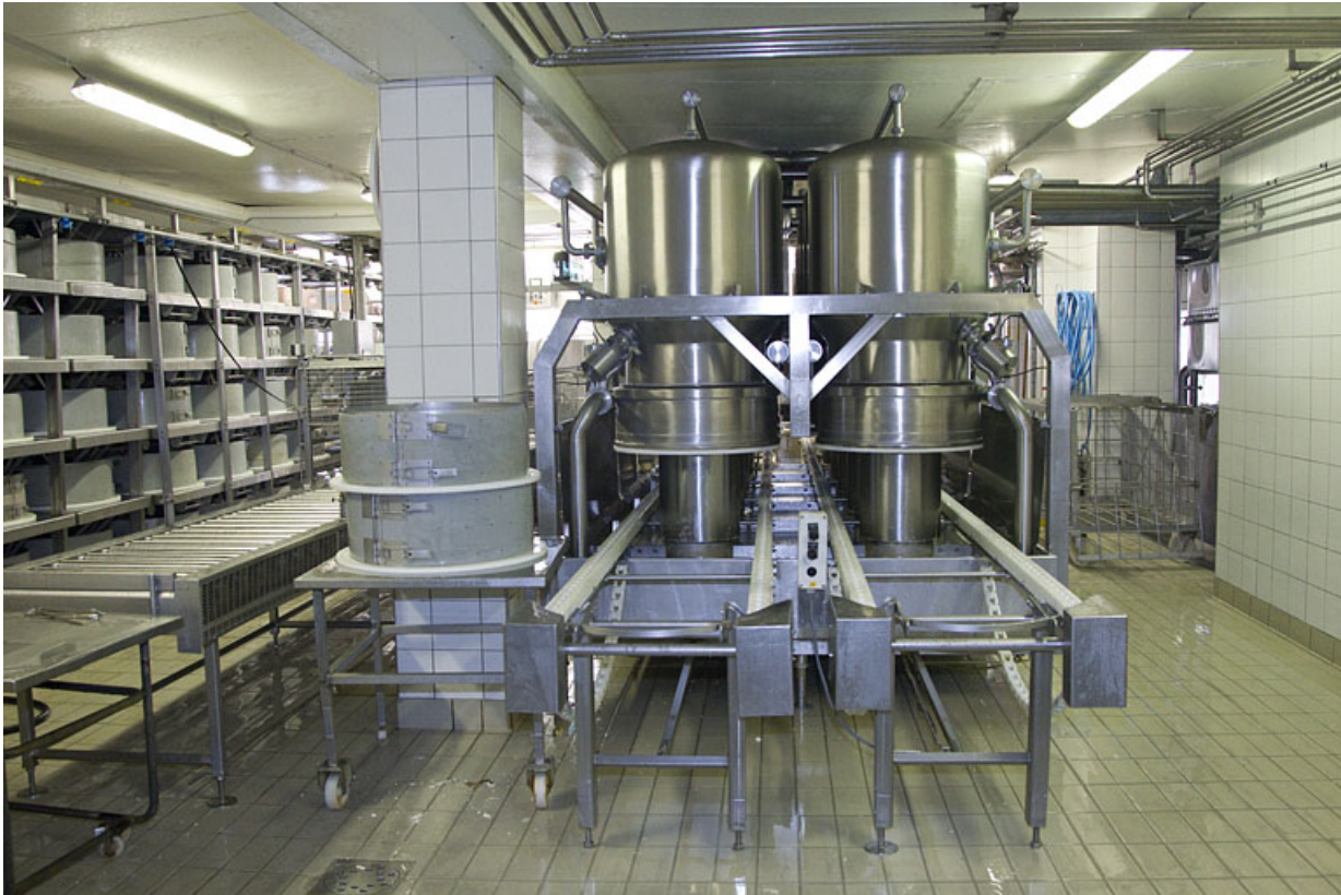
Fabrication du comté : installations de soutirage et de pressage.
