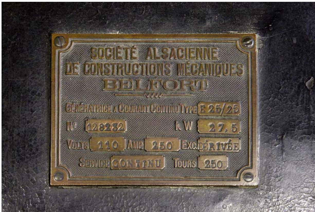
Centrale : plaque signalétique de l'excitatrice.
