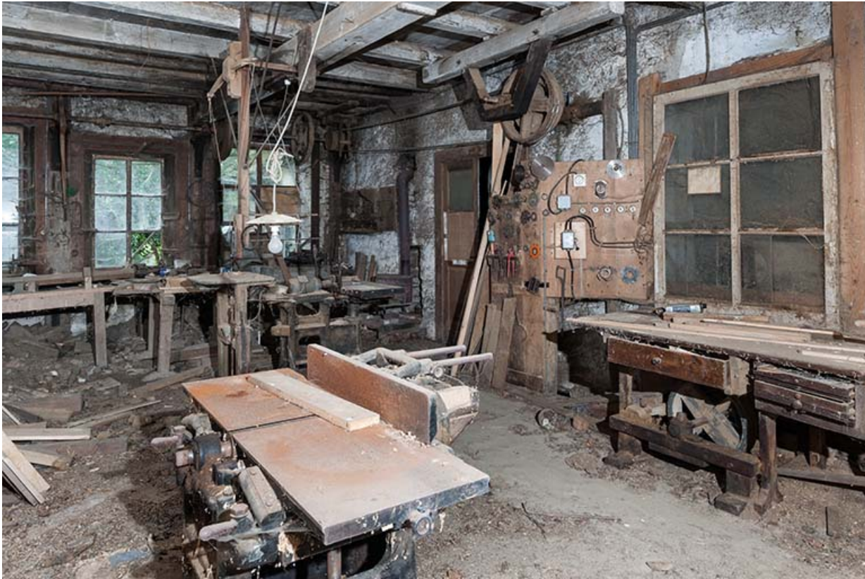
Atelier à l'étage de soubassement. Machine à raboter Betic (au premier plan).
