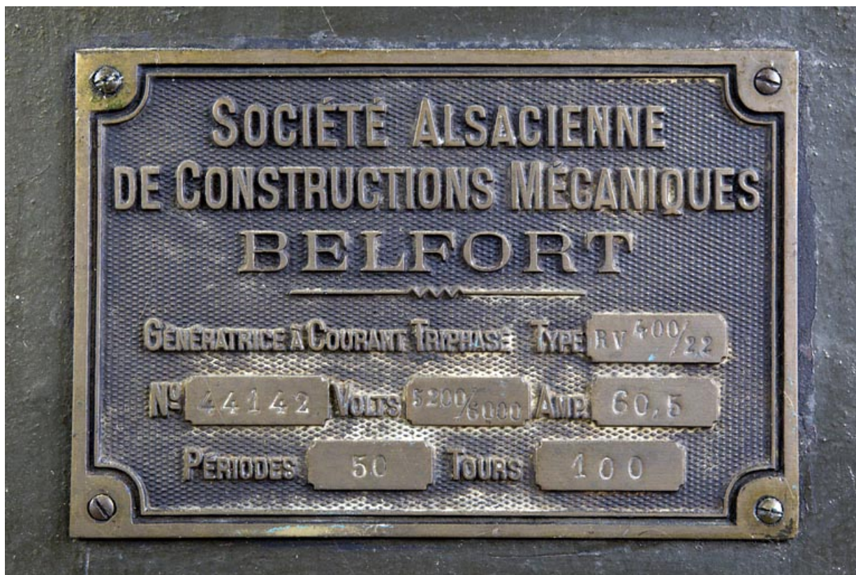
Plaque de constructeur d'un alternateur SACM.
