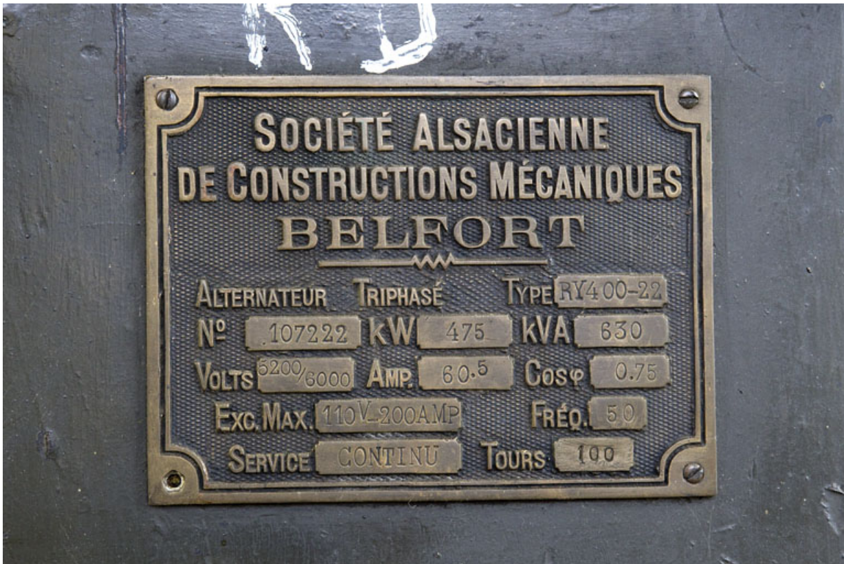
Plaque de constructeur d'un alternateur SACM.
