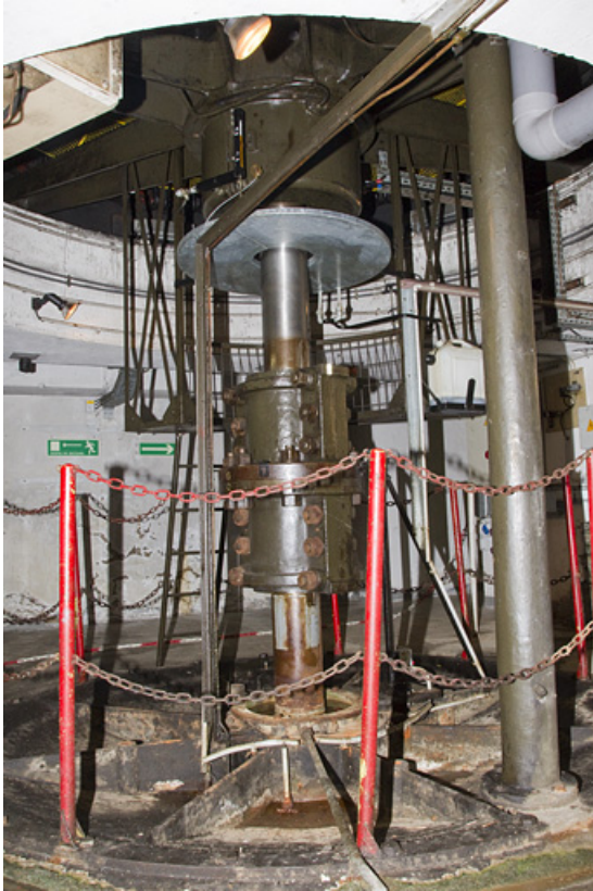
Détail de la transmission verticale d'une turbine.
