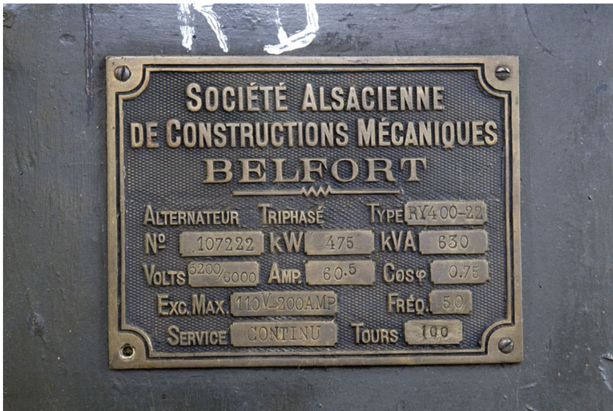
Plaque de constructeur d'un alternateur SACM.
