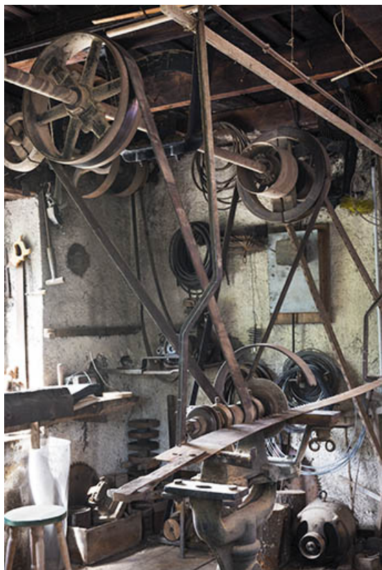
Affûteuse avec son mécanisme de transmission.
