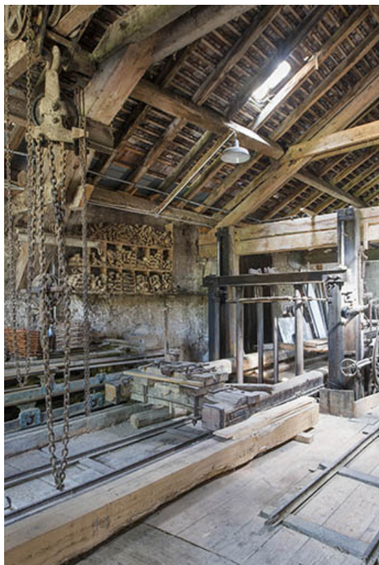
Atelier de scierie : le châssis multi-lames, son chariot et le palan.
