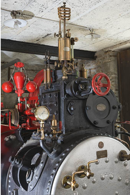
Partie supérieure de la machine : régulateur à boules, manomètre et graisseur oléomètre. 25, Rémondans-Vaivre, 14 rue du Moulin
