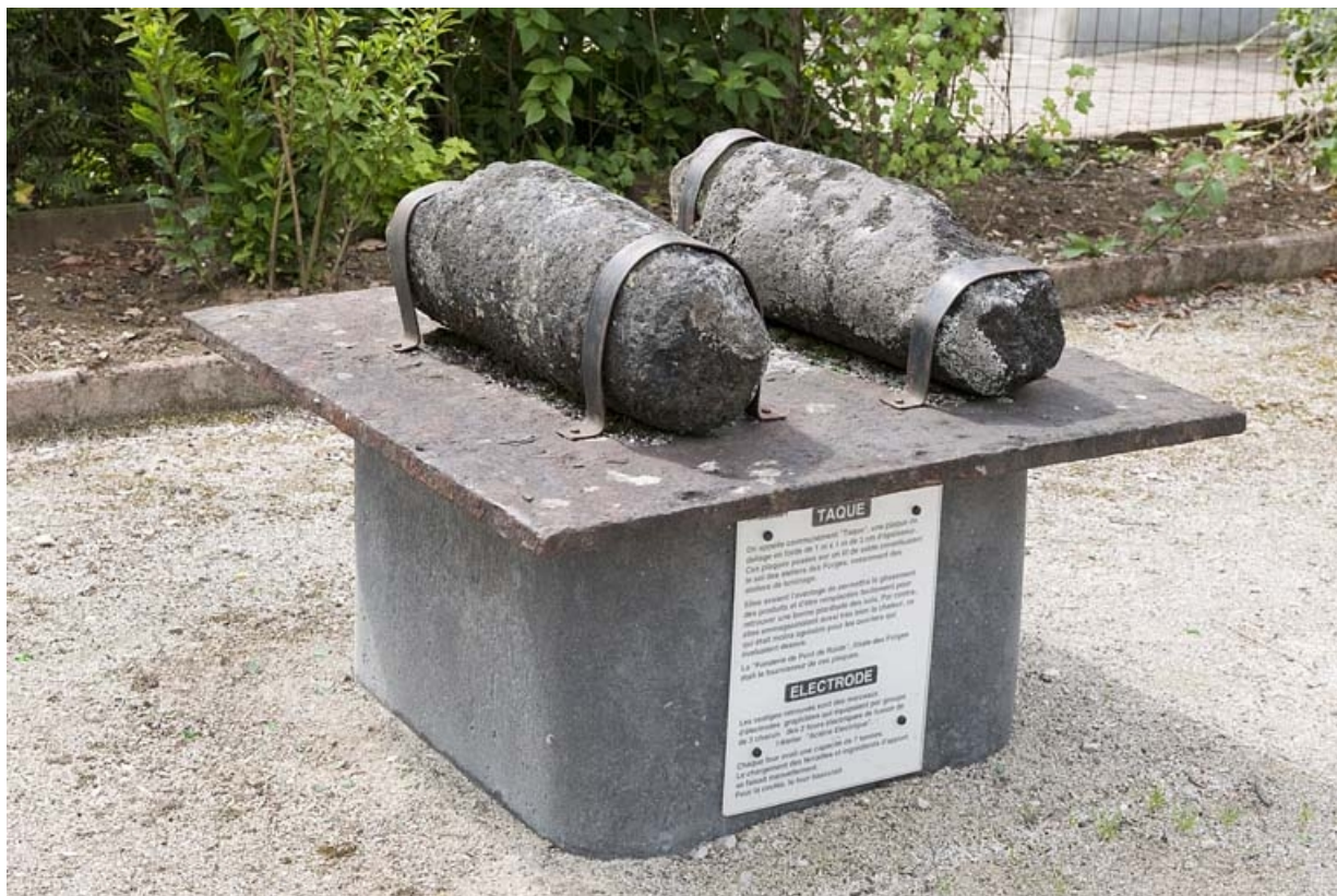
Pièces diverses exposées à proximité du site : électrodes des fours électriques posées sur une plaque de fonte (taque). 25, Audincourt rue du Four Martin, lieudit : les Forges
