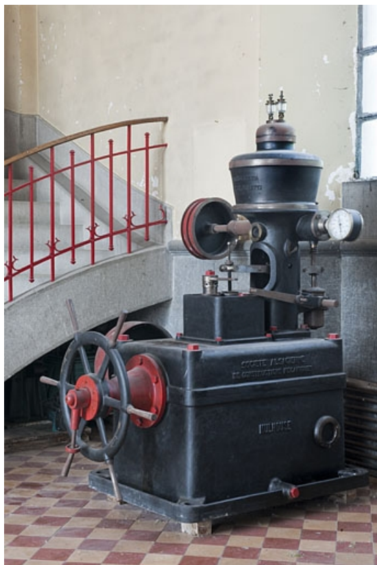
Détail d'un régulateur de la Société Alsacienne de Constructions Mécaniques (hors-service). 25, Mathay, lieudit : rue du Barrage
