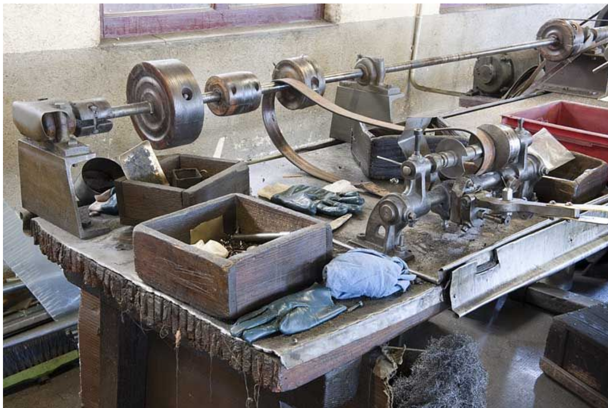
Atelier de décolletage sud. Tour horizontal. 25, Seloncourt, 79, 81 rue du Général Leclerc
