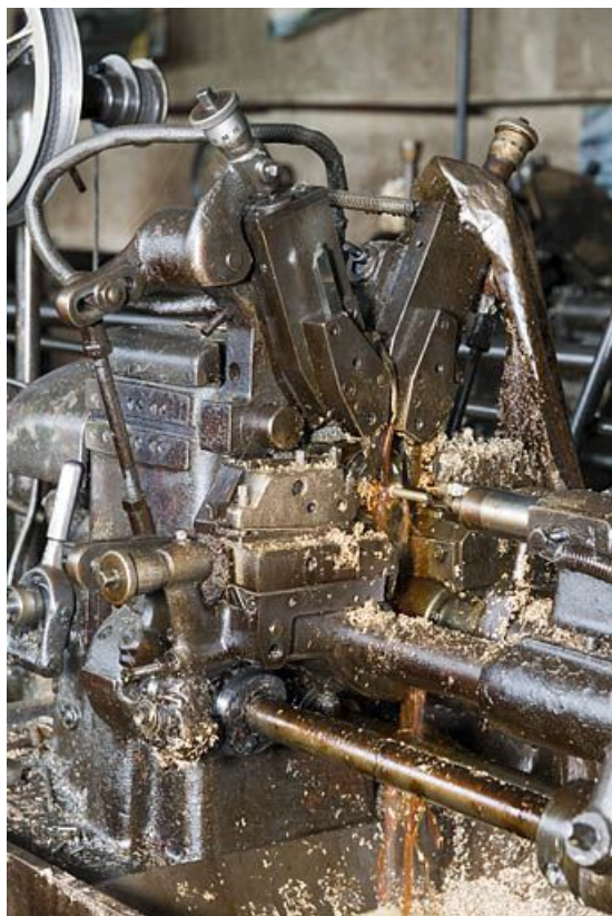
Atelier primitif. Machine à décolleter en action.
