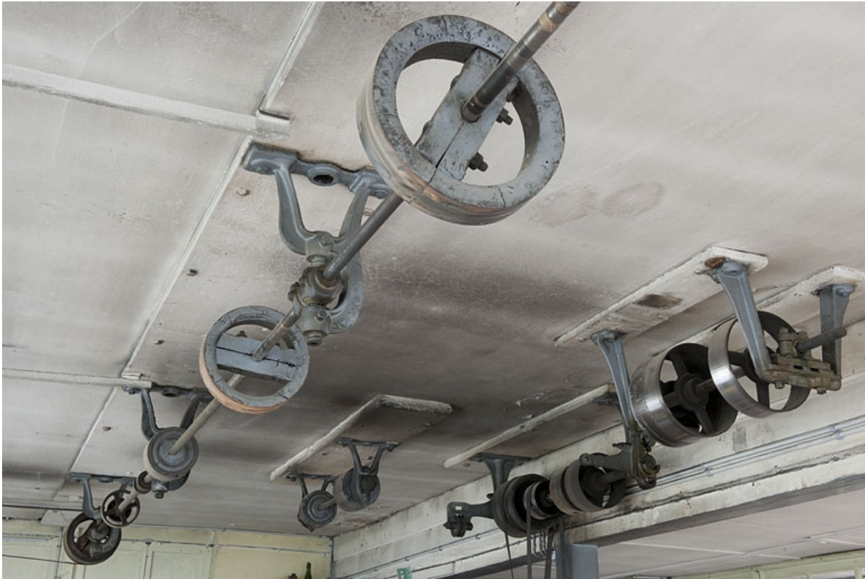
Intérieur de l'atelier. Système de transmissions.
