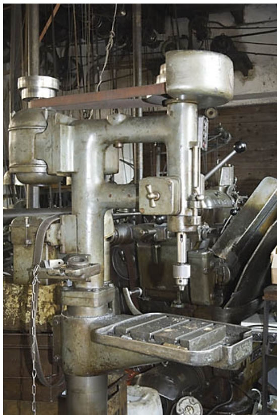
Perceuse à colonne (I) : vue rapprochée.
