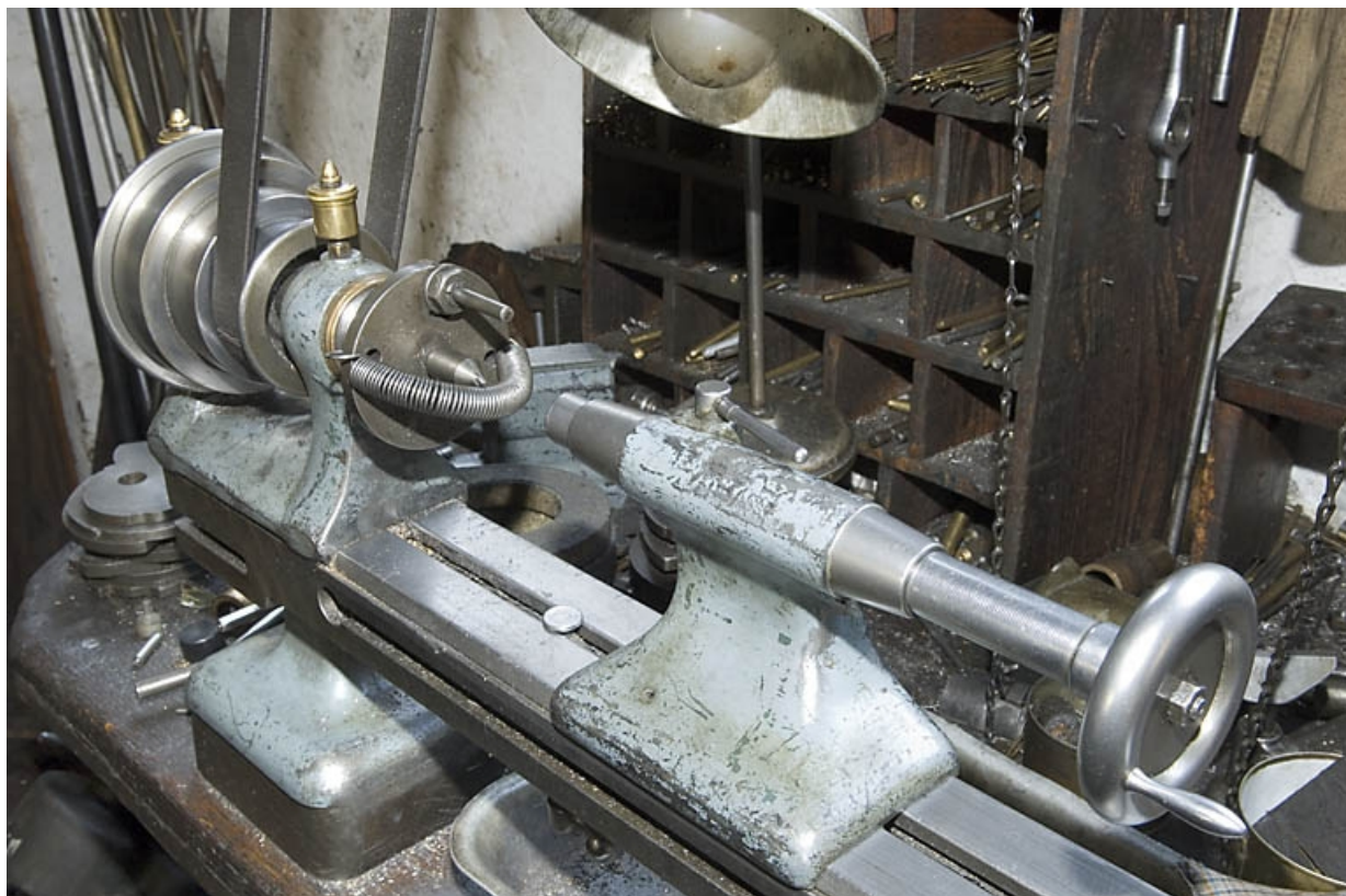
Tour horizontal Waltham (B). Détail de la poupée fixe et de la poupée mobile. 25, Besançon, 11 rue Larmet
