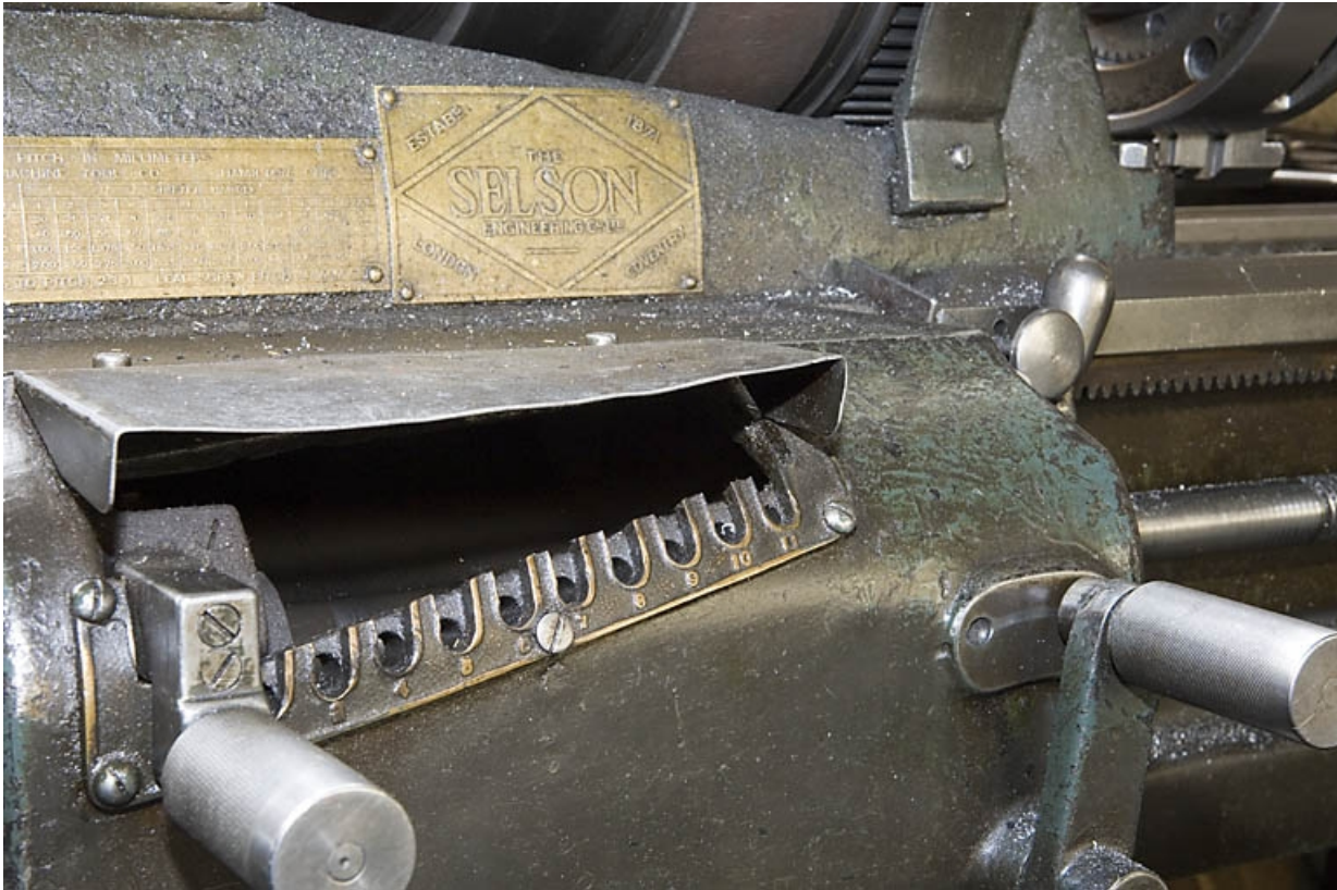
Tour horizontal parallèle Selson (A). Détail de la boîte de vitesses. 25, Besançon, 11 rue Larmet
