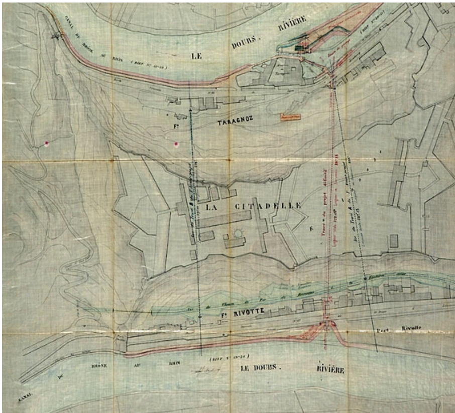
Dérivation sous la citadelle de Besançon. Plan de la dérivation et de ses abords, 1877. 25, Besançon Faubourg Tarragnoz 7, lieudit : îlot Tarragnoz
