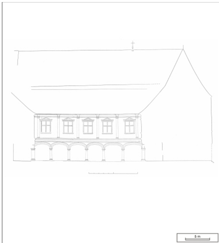
Restitution photogrammétrique de l' élévation de la façade est sur cour intérieure, avec coupe partielle.
