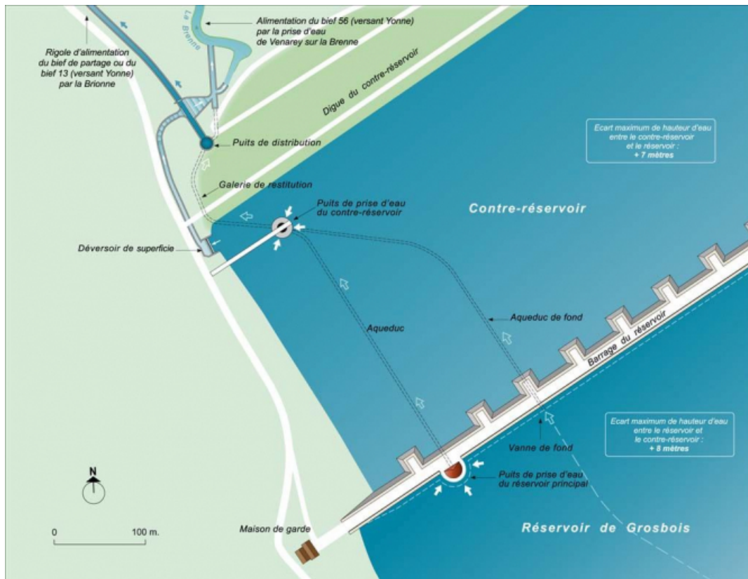
Plan schématique du réservoir de Grosbois, détail du barrage et du contre-réservoir.
