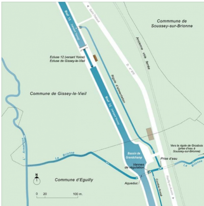
Plan schématique du réseau hydraulique aux biefs 12 et 13 du versant Yonne. 21, Gisse-le-Vieil, lieudit : bief 12 du versant Yonne
