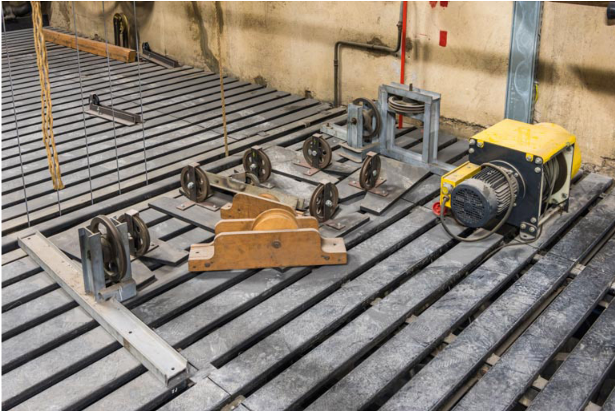
Cintre : moteur électrique et poulies.
