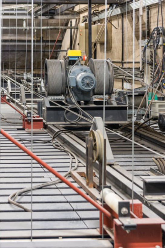
Cintre : moteur électrique d'une équipe.
