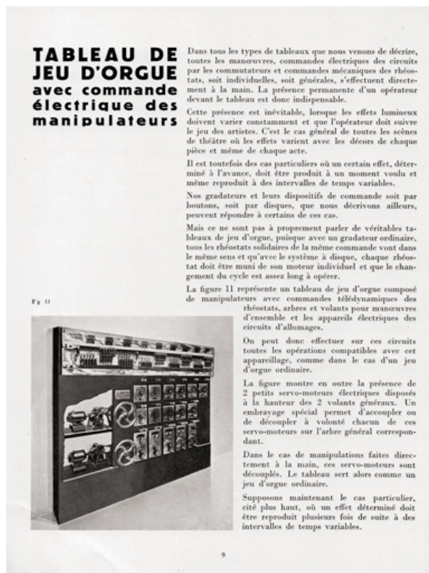
Cie générale de Travaux d'éclairage et de Force (Anciens Ets Cléménçon). Appareillages électriques pour théâtre [catalogue]. Tableau de jeu d'orgue avec commande électrique des manipulateurs. S.d. [années 1940-1950].
