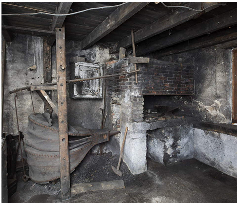
Forge : soufflet, foyer et établi (à droite).
