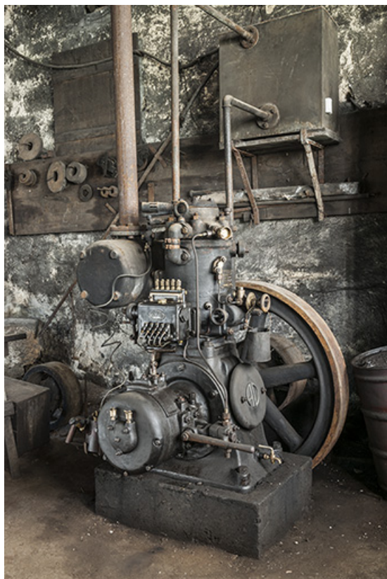
Atelier de mécanique. Moteur semi-diesel Douge. Vue de trois quarts droite.
