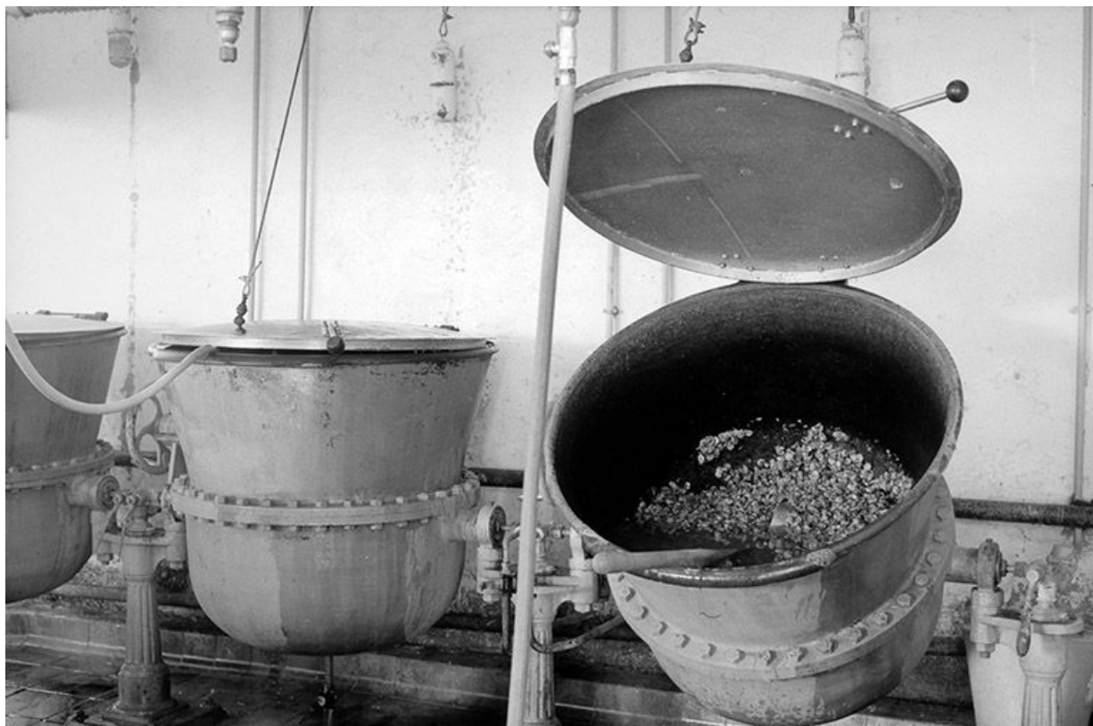
Conserverie Ménétreel, atelier de fabrication (3) : marmites de première cuisson.
