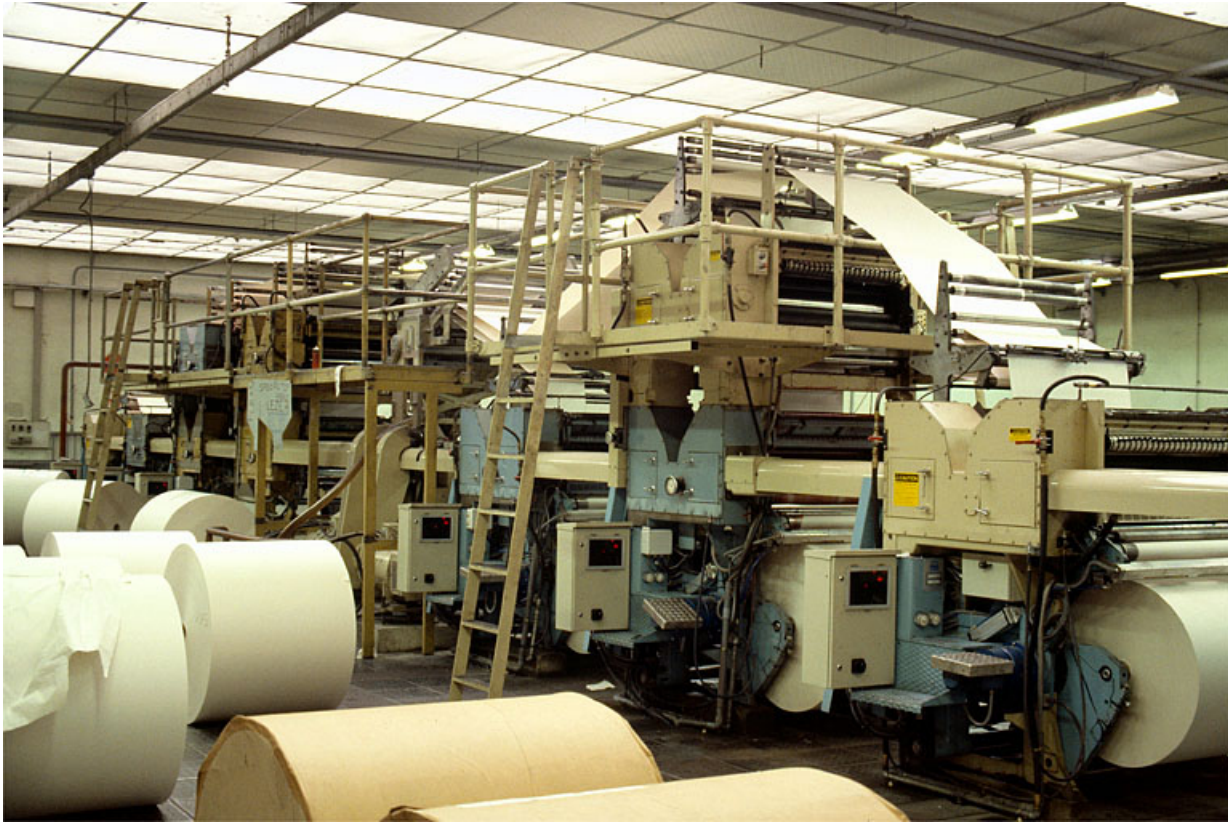
Atelier de fabrication : presse rotative Rockwell.
