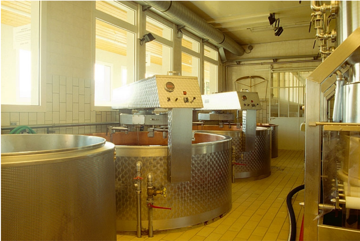
Cuves de fabrication du comté.
