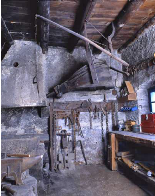
Intérieur de la forge, le soufflet et les outils.
