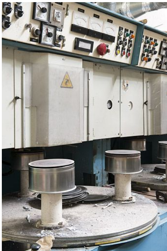
Poste de brasage par induction (pose du fond).
