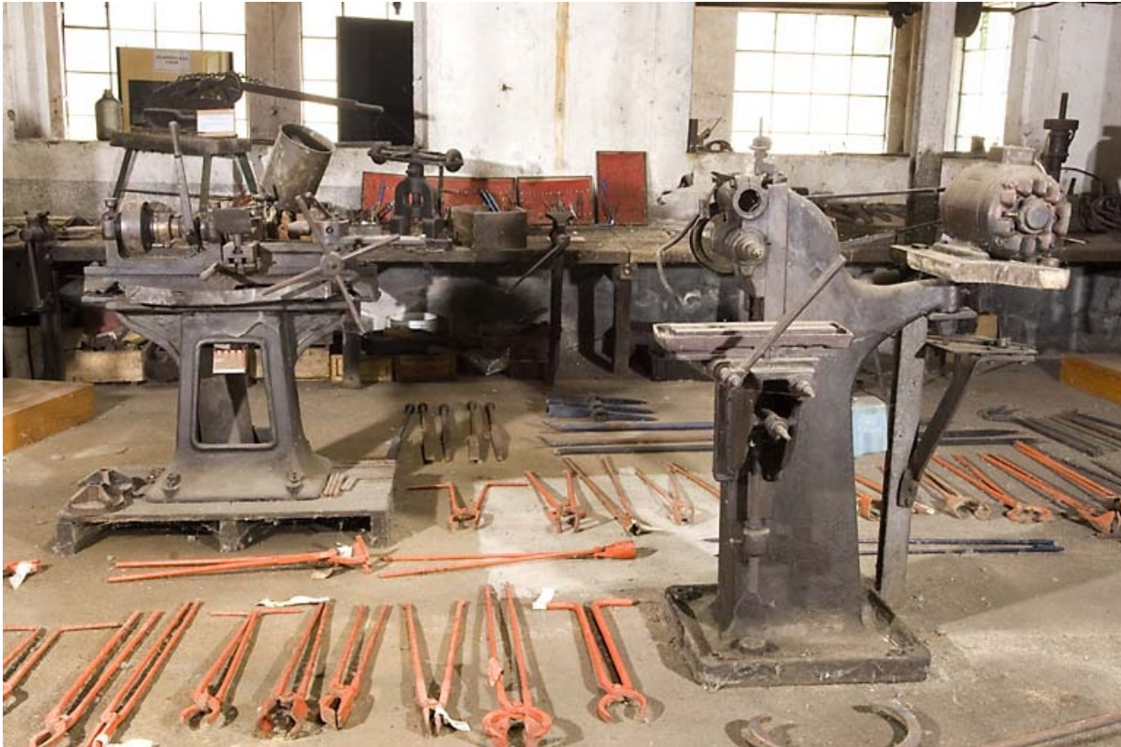
Atelier ouest. Tour horizontal Cazeneuve et Faiseuse Ernault.
