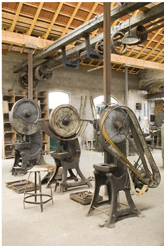
Atelier ouest. Presses "col de cygne".
