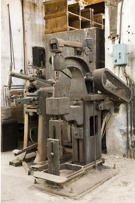
Atelier ouest. Riveteuses Pontelec et Guillemain.
