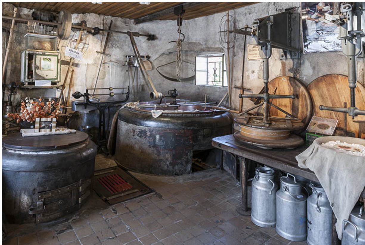
Salle de fabrication. Chaudières et presses sur table.
