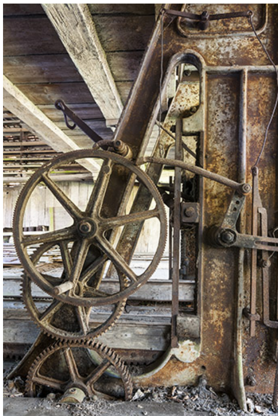
Détail du mécanisme d'entraînement du châssis.
