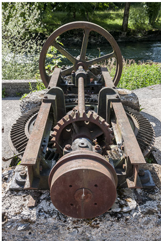
Départ de la transmission de la turbine.
