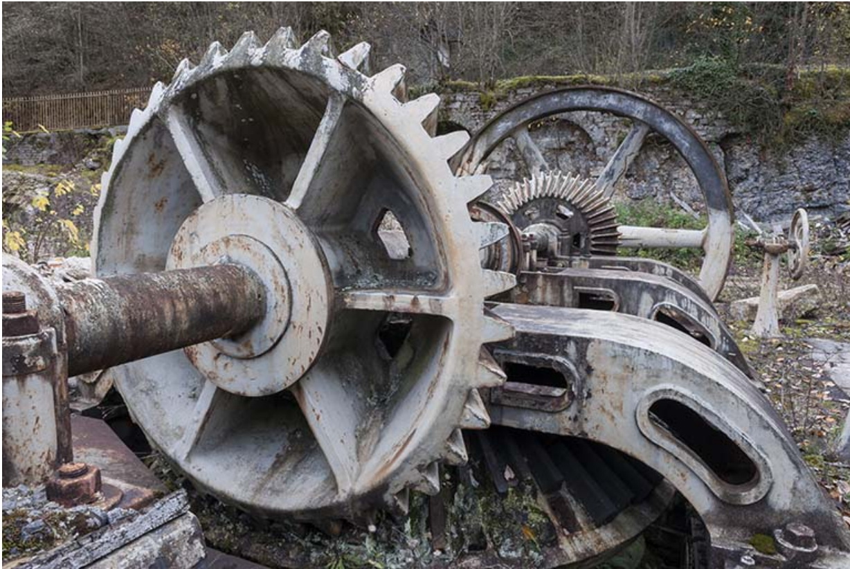
Turbine double. Transmission par engrenage conique.
