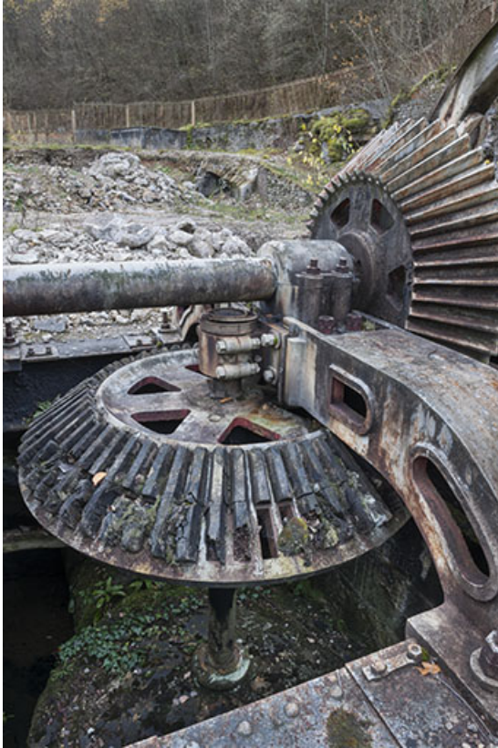
Turbine double. Détail des engrenages coniques.
