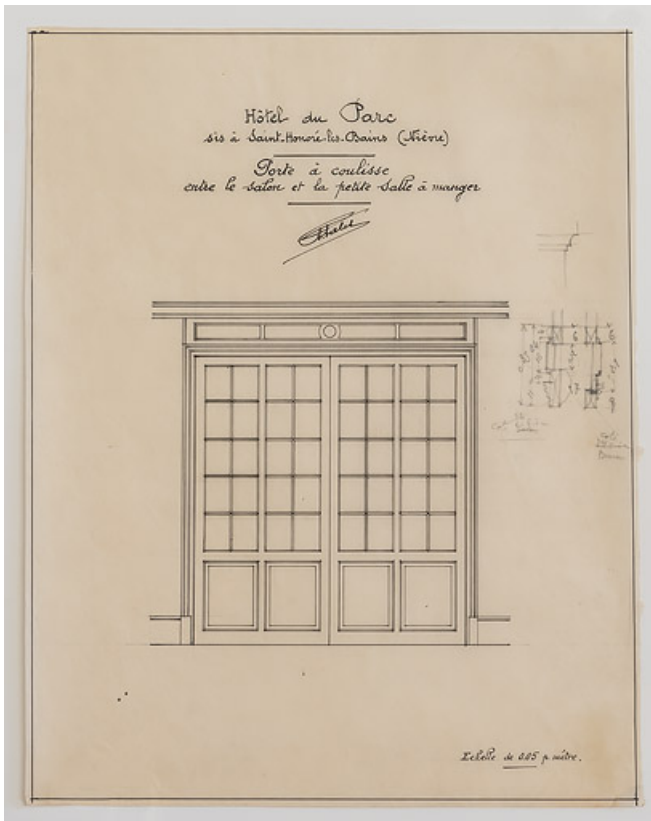
Porte coulissante séparant la petite salle à manger et le salon, projet d'Auguste Palet (1921). 58, Saint-Honoré-les-Bains, 1 avenue Jean Mermoz
